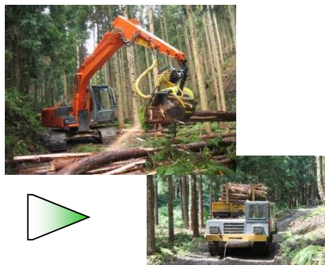
高性能林業機械による 伐採収集運搬
